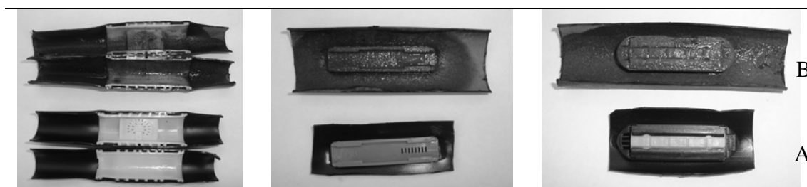
Figura 1 - Modelos de gotejadores novos (A) e com a presença de mucilagem formada pelas ferrobactérias (B).
